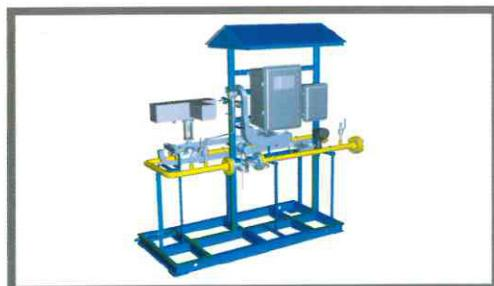
БЛОК ЗАМЕРА И РЕГУЛИРОВАНИЯ РАСХОДА ГАЗА
