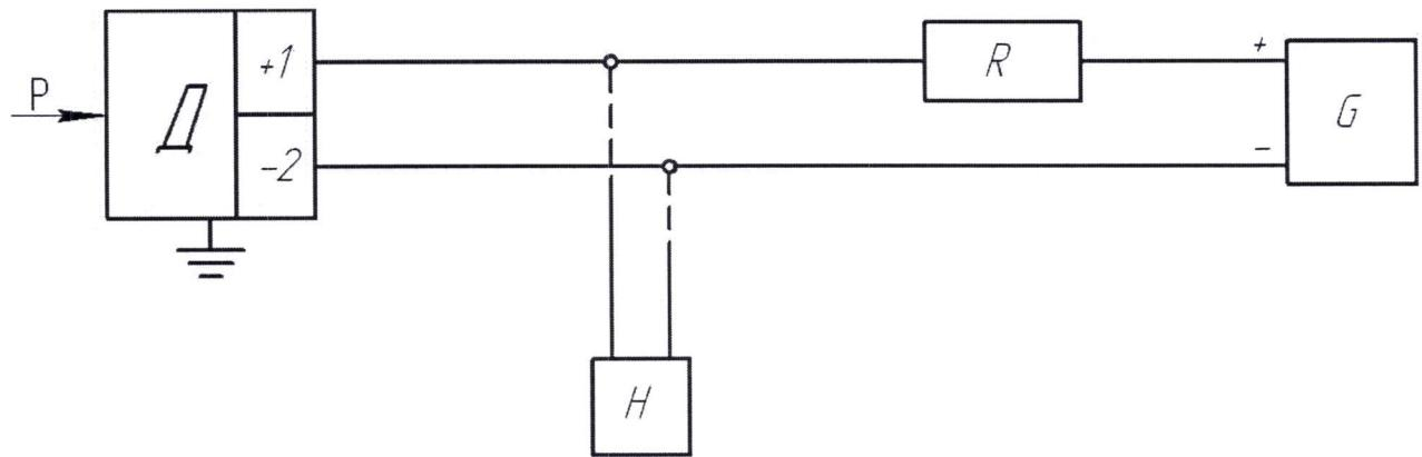
P – входная измеряемая величина; Δ – поверяемый преобразователь; G – источник питания постоянного тока; R – нагрузочное сопротивление; значение сопротивления – в соответствии с условиями поверки; H – портативный компьютер или другое цифровое устройство, поддерживающее коммуникационный протокол;
