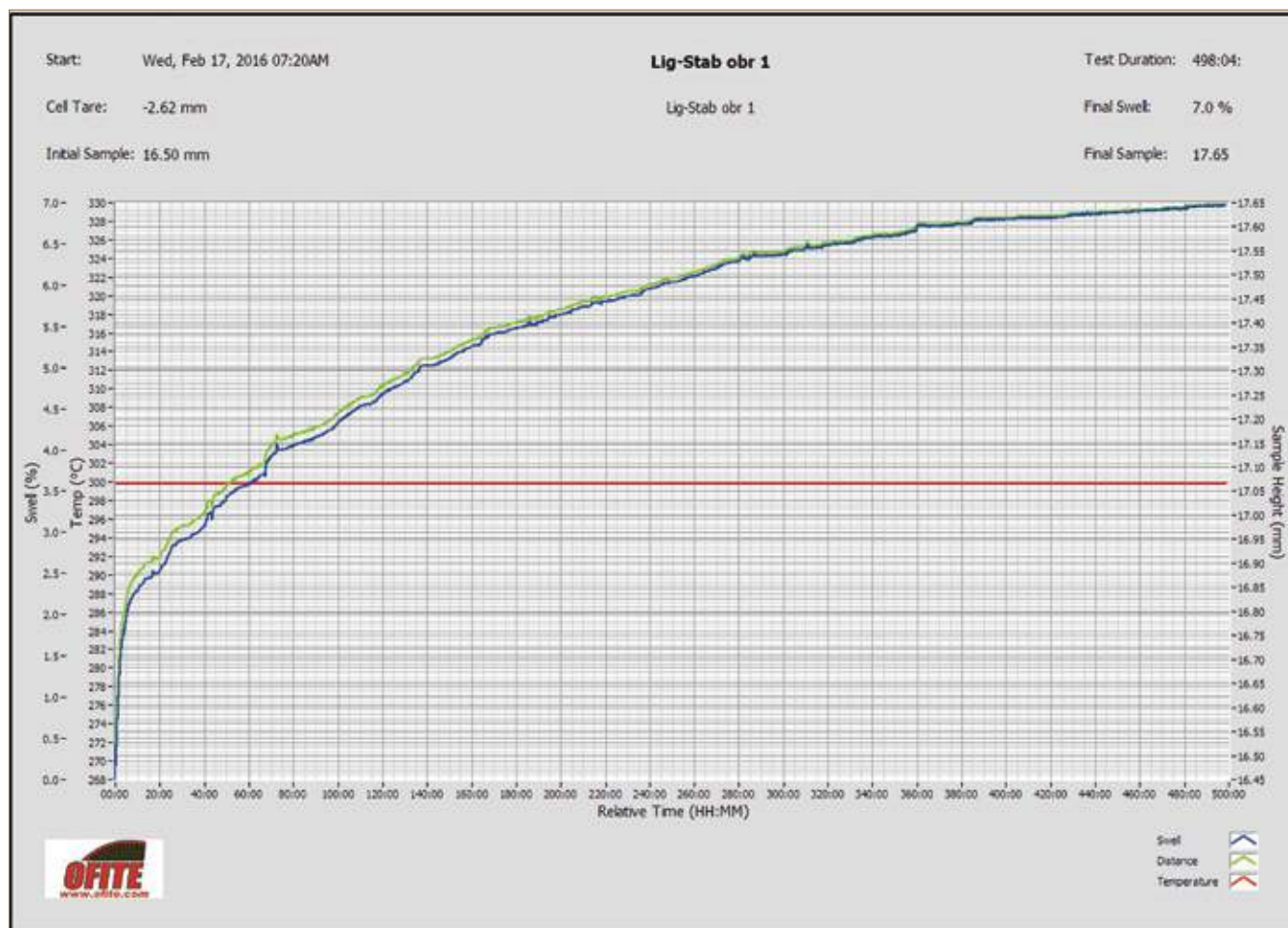
Рис.1. Кривая набухания Кыновских глинистых отложений в биополимерном хлоркалиевом буровом растворе, содержащем 2,0% ингибитора «ЛИГ-СТАБ».
