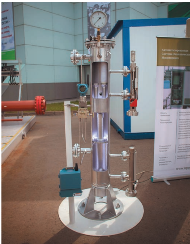
Фото 1. Выставочный образец двухступенчатого фильтра-коалесцера газа ГКС
