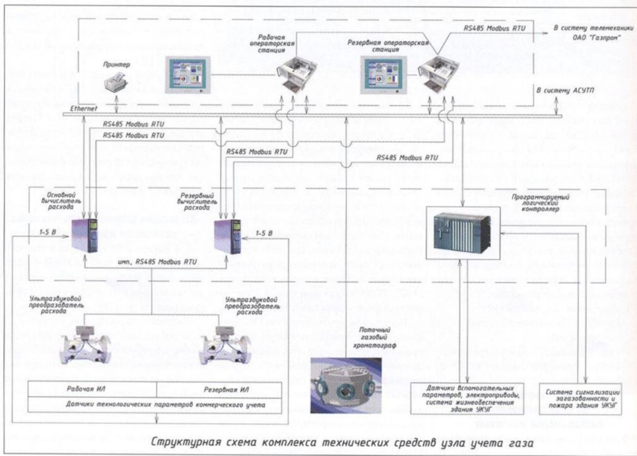
Структурная схема комплекса технических средств узла учета газа
