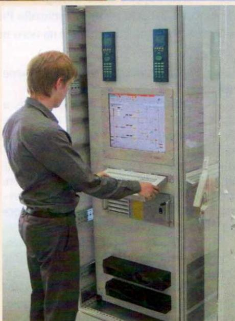
который позволяет с высокой точностью каждые десять минут без участия операторов определять концентрацию ацетона и примесей в нём воды и метанола; концентрацию остаточных количеств ацетона и фенола в сточной воде. Это очень важно, так как фенол — сильнодействующий яд, вызывающий нарушение нервной системы. После успешного выполнения этой работы ОАО «Казаньоргсинтез» заказало ещё хроматографы для оснащения завода органических продуктов и склада углеводородов.
